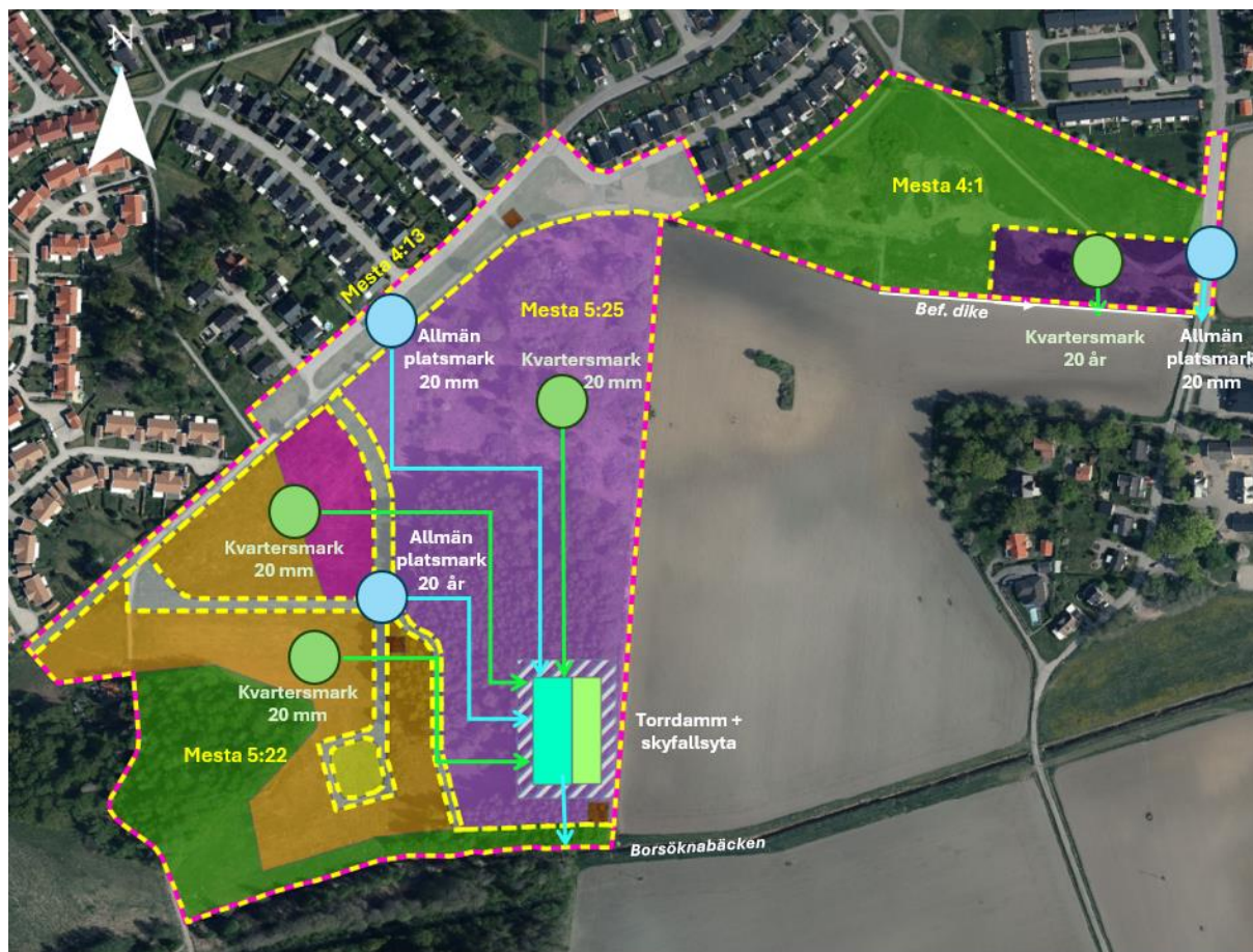
Figur 15. Schematisk systemlösning för dagvatten. Bakgrund: Ortofoto från Lantmäteriets visningstjänst.
