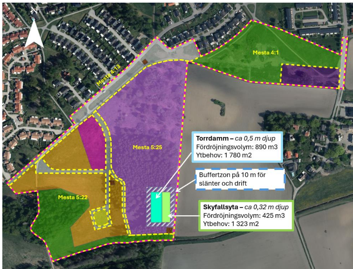
Figur 19. Figuren visar den erforderliga storleken på torrdammen och skyfallsytan. Dammens utformning är bland annat beroende av bäckens höjd, möjliga ledningsdjup och grundvattennivåer. Möjlig utsläppsnivå från dammen till bäcken är under utredning. Bakgrund: Ortofoto från Lantmäteriets visningstjänst.
