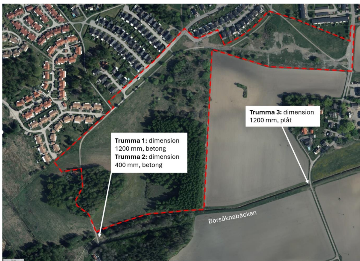
Figur 6. Befintliga trummors dimension och lägen i förhållande till planområdet i rött. Bild: SCALGO Live.
