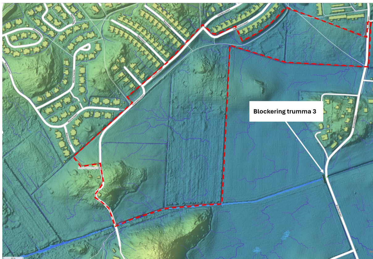
Figur 10. Bäckens kapacitet i den mest begränsande sektionen (900 l/s) applicerad som regndjup (3,2 mm) i SCALGO Live vid blockering av trumma 3 ger ingen marköversvämning.
