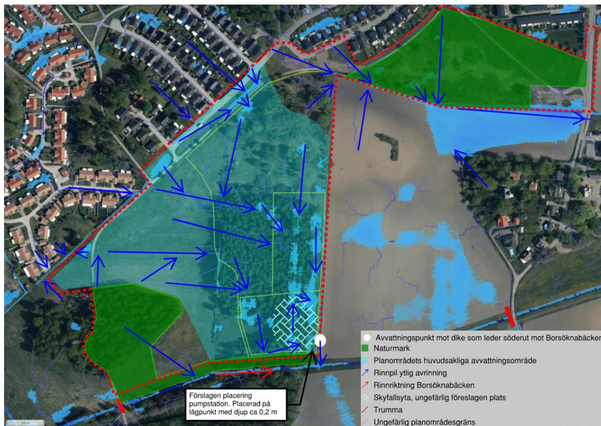
Figur 12. Befintliga lågpunkter inom och utom planområdet markerade med blå ytor. Turkosfärgat område avser område som avvattnar mot den föreslagna skyfallsytan, med utlopp mot diket (vit punkt). Planområdets östra delar avvattnar via lågpunkt på åkern vidare österut mot Borsöknabäcken. Gröna ytor avser områden där naturmark kommer behållas. Bakgrund: Ortofoto från Lantmäteriets visningstjänst.
