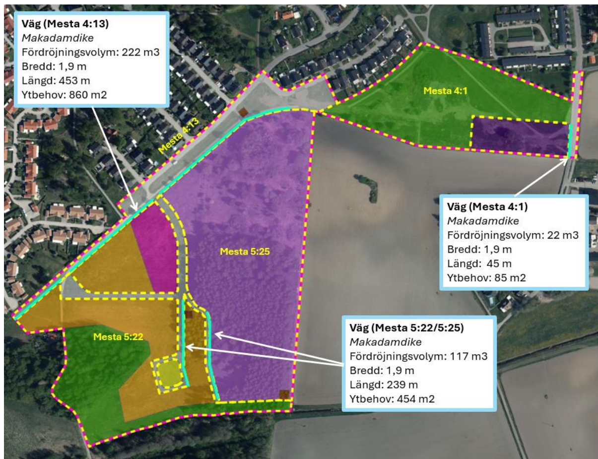
Figur 18. Yta för makadamdiken som behövs för hantering av den erforderliga fördröjningsvolymen för vägarna (allmän platsmark). Placering och utformning av de föreslagna anläggningarna avgörs vid ett senare skede. Bakgrund: Ortofoto från Lantmäteriets visningstjänst.
