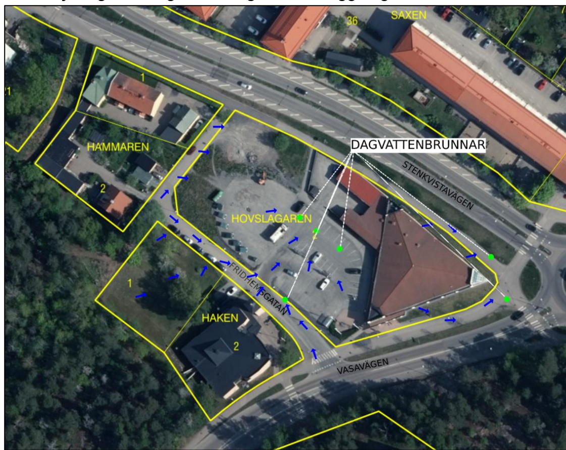
Figur 17. Översikt avrinningsvägar och dagvattenbrunnar vid Haken 1 och Hovslagaren 2:1.
