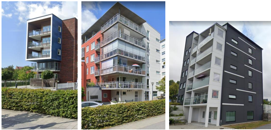
Figur 8-1 Exempel på bullerdämpande utformning av fasader i Lund.
