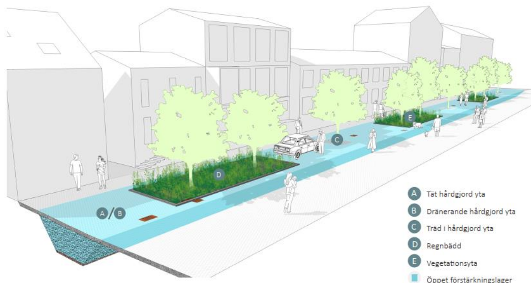
Figur 16. Exempel på utformning av ett bgg-system för huvudgatan. Exemplet är hämtat från Levande stadsrum 3.1, edge.
