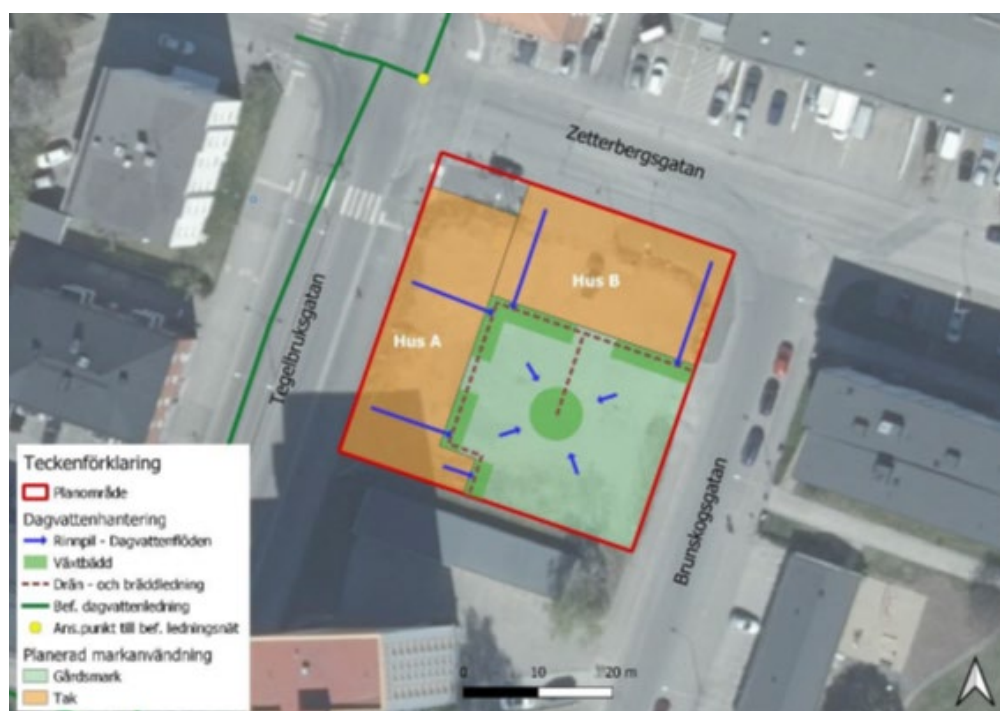
Figur 21. Föreslagen dagvattenhantering inom kvartersmaken. Takyterna avvattnas mot och omhändertas inom gårdsmarken. Total area för illustrerade växtbäddar är ca 145 m 2 . Drän-
