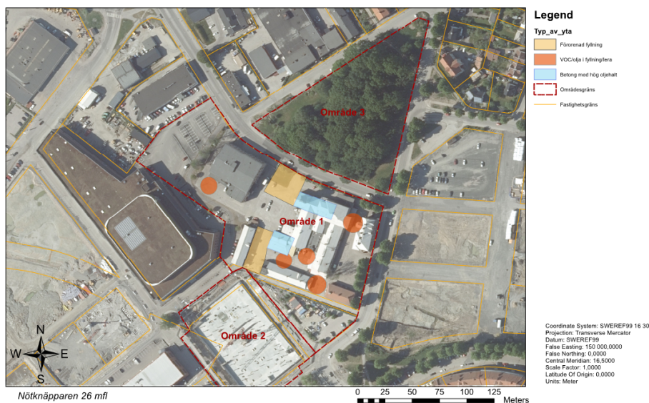
Figur 1. Områden som med säkerhet bedöms vara i behov av riskreduktion med avseende på risk för inandning av ånga är markerat med gul yta. Blå bakgrund avser betong som kräver åtgärd. Total yta för mark utanför byggnad är 1695 m 2 och betongytan är 920 m 2 . Orangea runda markeringar avser ytor som misstänks vara påverkade av olja/VOC och är vardera ungefär 350 m 2 till ytan.
