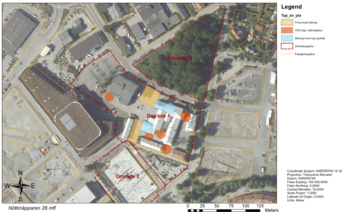
Figur 5.4 Områden som med säkerhet bedöms vara i behov av riskreduktion med avseende på risk för inandning av ånga är markerat med gul yta. Blå bakgrund avser betong som kräver åtgärd. Total yta för mark utanför byggnad är 1695 m 2 och betongytan är 920 m 2 . Orangea runda markeringar avser ytor som misstänks vara påverkade av olja/VOC och är vardera ungefär 350 m 2 till ytan.
