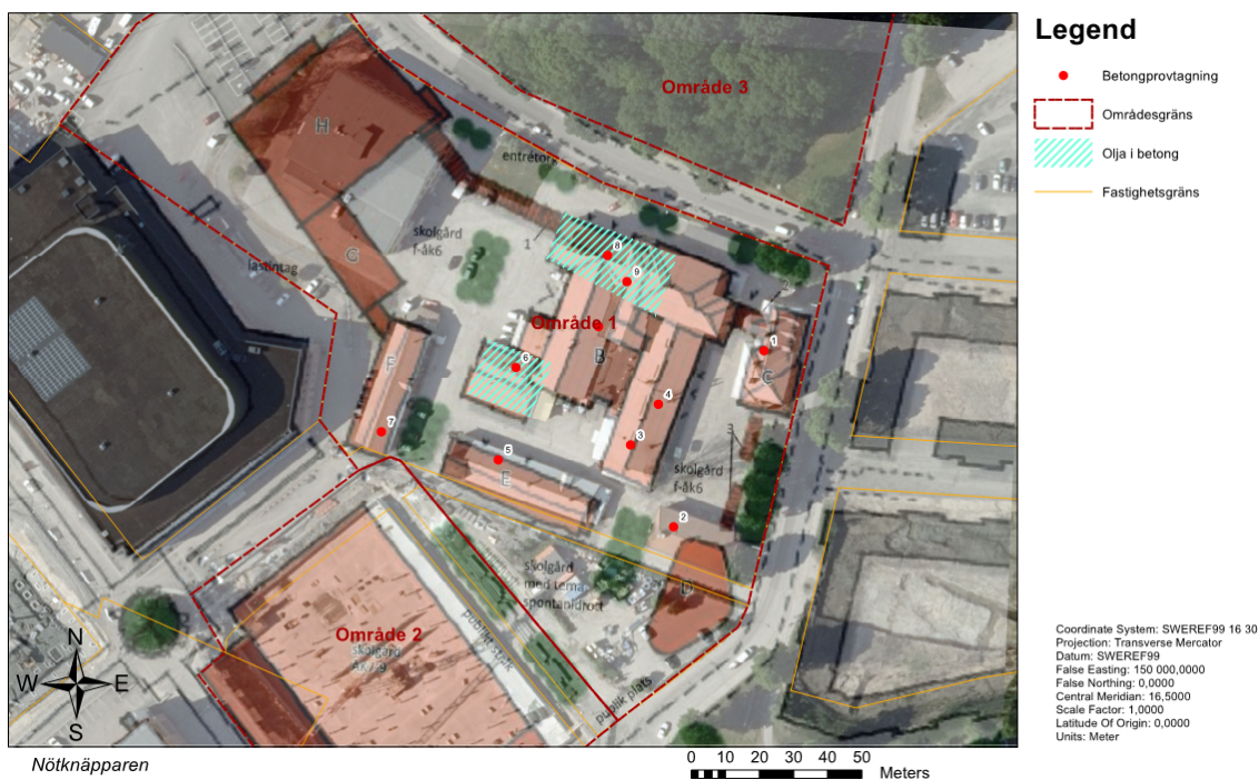
Figur 3.3 Provtagningspunkter i betonggolv och ytor där tydligt förhöjda oljehalter påvisats har markerats med streckade linjer, se även bilaga 2.
