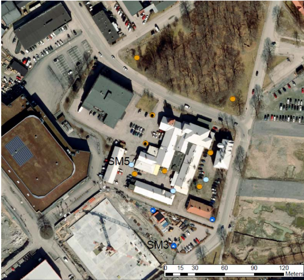
Figur 4-1 Provtagningsplan avseende grundvattenrör från Norconsult. De olika färgerna anger typ av rör och om även jordprover uttagits (se rapport Norconsult, 2019-07-09). Det är totalt 14 st grundvattenrör och de provtagna grundvattenrören SM3 och SM5 har markerats med namn. Övriga grundvattenrör var torrlagda.
