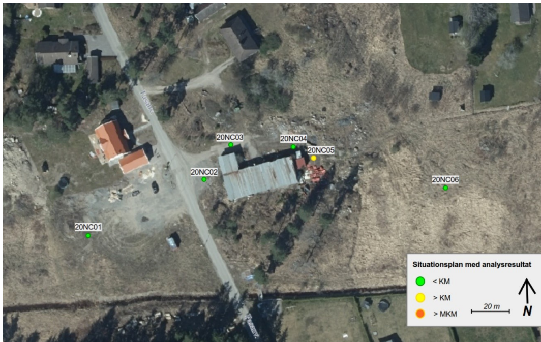
Figur 5. Markprovtagningar inom planområdet markerat med gröna och gula cirklar. I den gula cirkeln överstiger halterna av föroreningar naturvårdsverkets riktvärde för känslig markanvändning (KM) Källa: (Norconsult AB, 2020).
