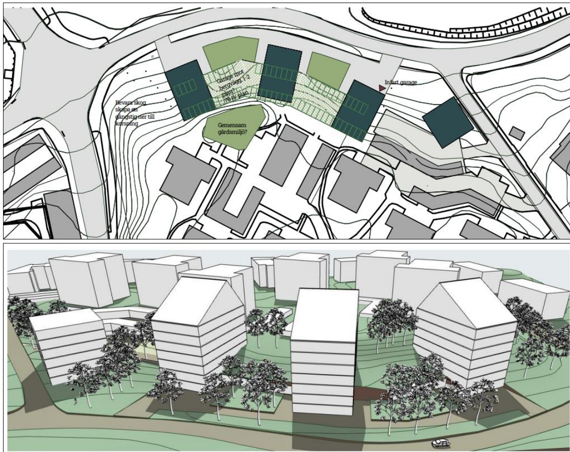
Figur 2 Skiss över planerad anläggning i plan och 3D vy, tre sutteränghus i 8 våningsplan, samt ett punkthus i 6 våningar. 3D-Vyn mot söder. Källa: Archus Arkitektur,
