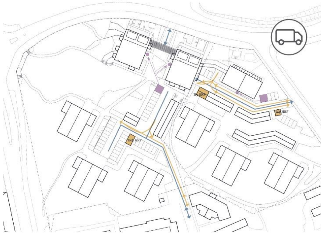
Körvägar för sopbilen med tänkta körvägar markerade med gult och angöring för motorfordon med blått. Archus.
