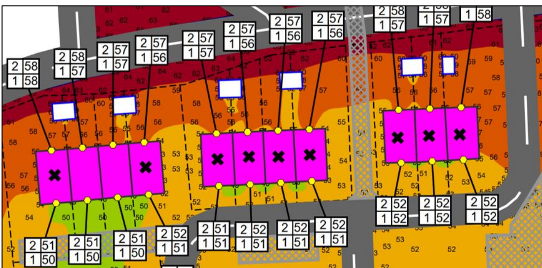
Figur 4. Urklipp ur bilaga 1. Flera bostäder har förhöjd ekvivalent ljudnivå vid uteplats, dessa har markerats med kryss.
