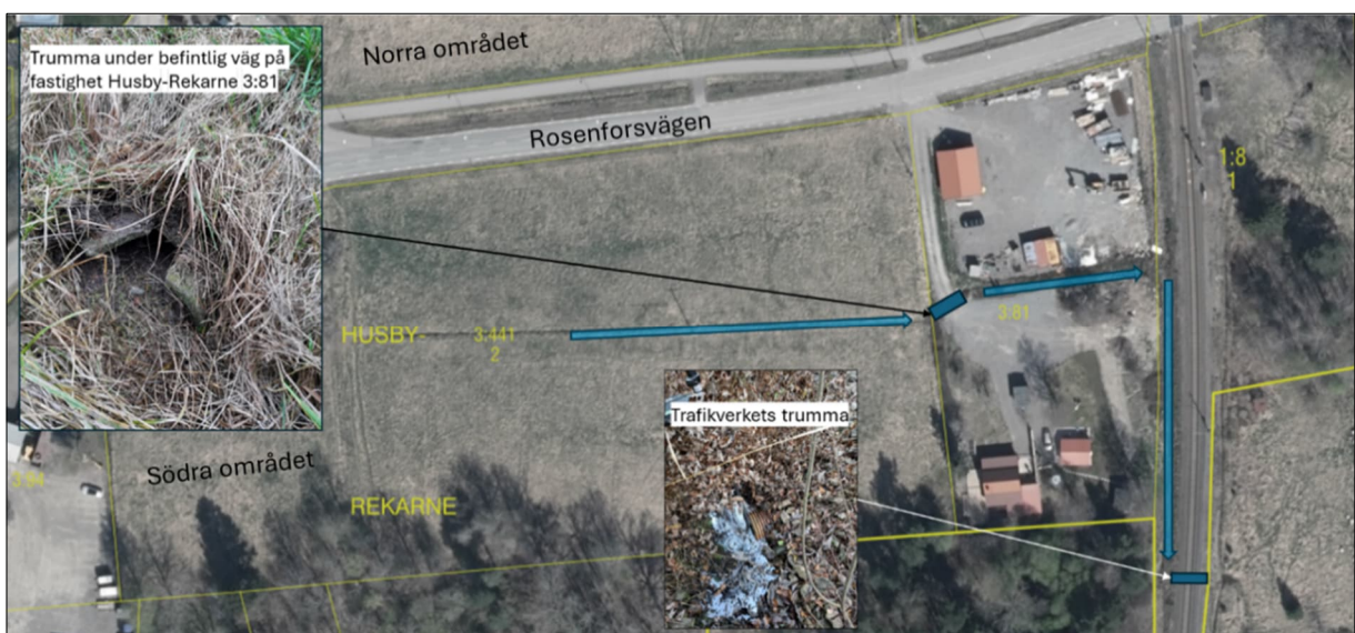
Figur 8 Rinnvägar från södra området vidare till diket längs banvallen via fastigheten Husby-Rekarne 3:81. Bilden på inlopp av trumman tagits vid platsbesöket utfört i november 2024).
