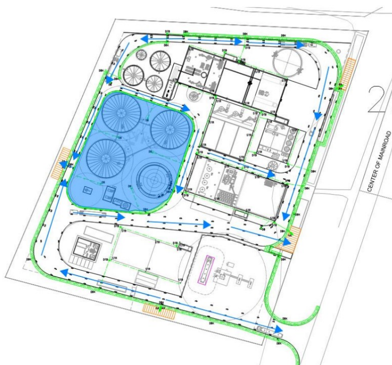
Figur 1, visar dagvattensystem för planerad Sevesoanläggning.
