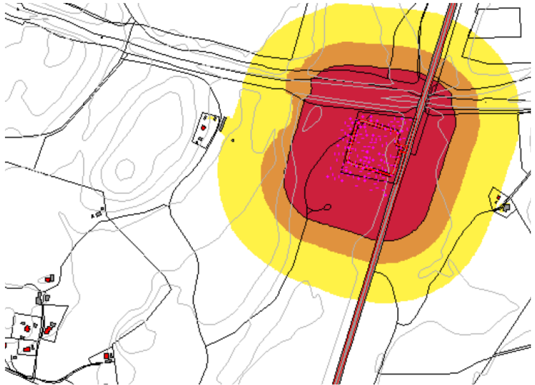
Figur 12. Utbredning av buller från biogasanläggningen. Röd färg: industribuller över 50 dBA ekvivalent ljudnivå. Orange färg: industribuller över 45 dBA. Gul färg: industribuller över 40 dBA.
