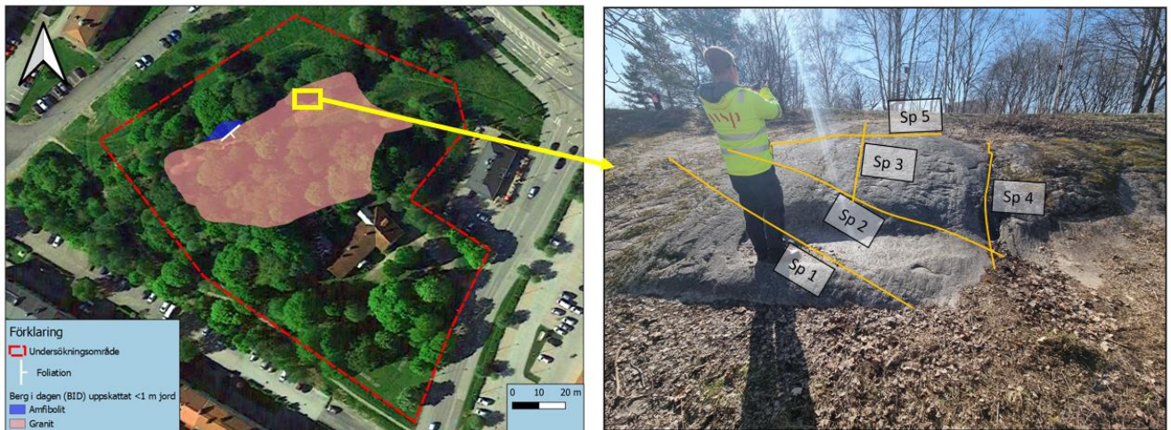
Figur 6. Till vänster anvisas den sprickkarterade berghällen med gul rektangel och pil. Till höger visas de fem sprickor som mättes och indelades, bild visar vy mot sydost.
