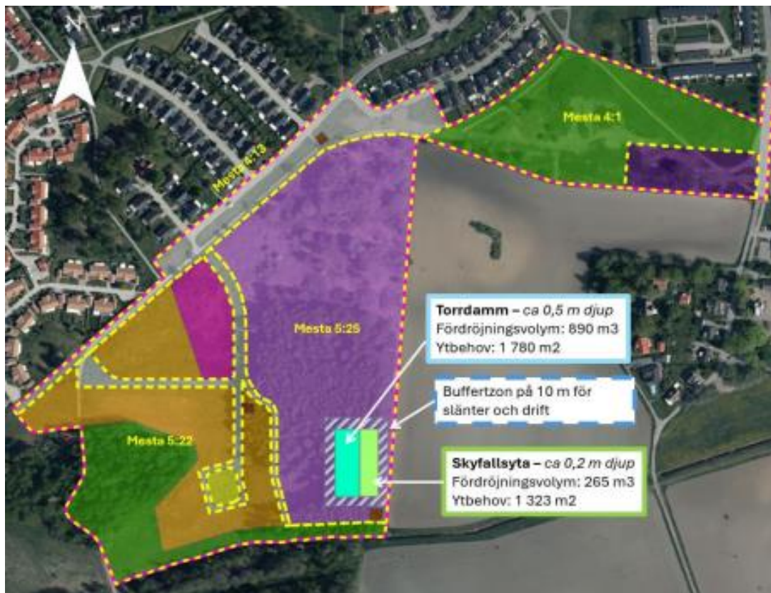
Figur 4. Dimensioner torrdamm och schematisk placering. Dagvattenutredning Mesta, Bjerking GH 2024-09-06.
