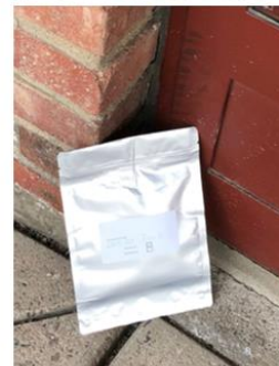
Prov 11 – fog runt fönster lågdel . Innehåller höga halter av PCB, utgör FA.
