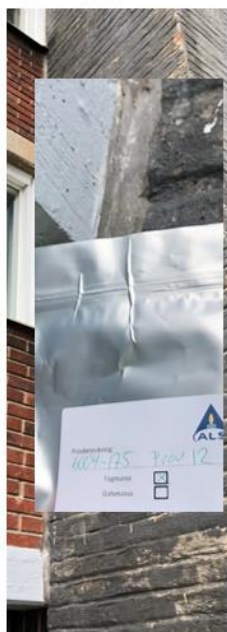
Prov 12 – fog Längs hela gråa mur och vägg. Innehåller höga halter av PCB, utgör FA.
