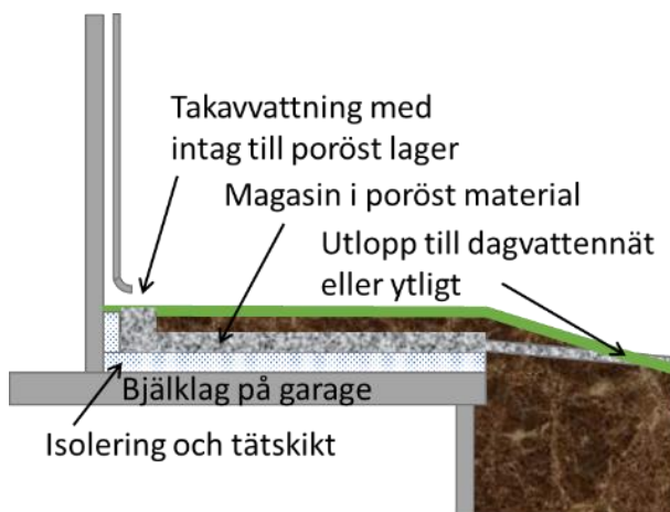
Figur 28. Principskiss på fördröjning av vatten på bjälklag.
