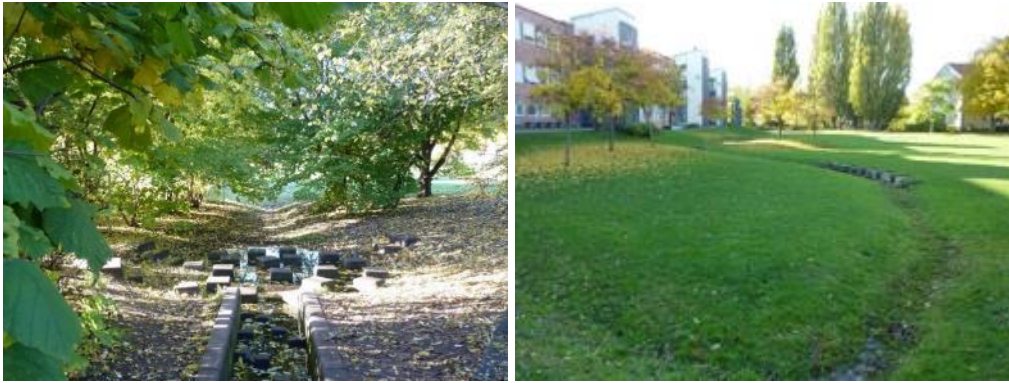
Figur 25. Exempel på utformning av en infiltration i nedsänkt grönyta. Foto: WRS
