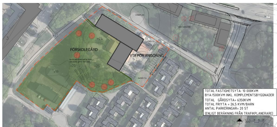
Figur 34: Förslag för parkering och fria yta för förskolan. Inom förskolegården redovisas skyddsvärda träd i orange.
