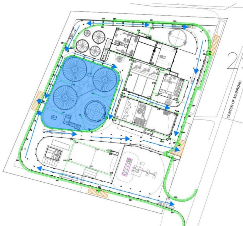
Figur 6, visar dagvattensystem för planerad Sevesoanläggning.
